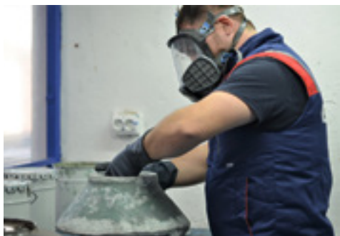
Рис. 3. Процесс нанесения композитного состава
