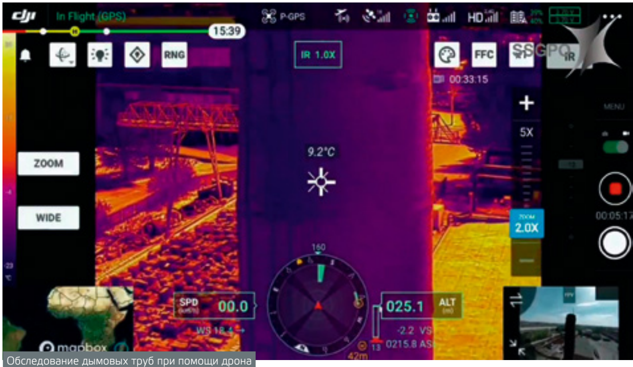
Обследование дымовых труб при помощи дрона
