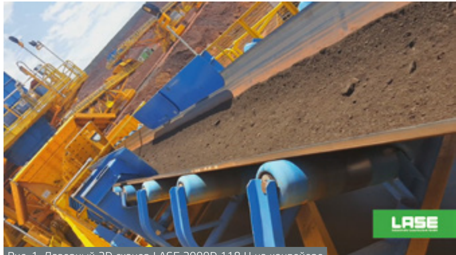
Рис. 1. Лазерный 2D-сканер LASE 2000D-118-H на конвейере
