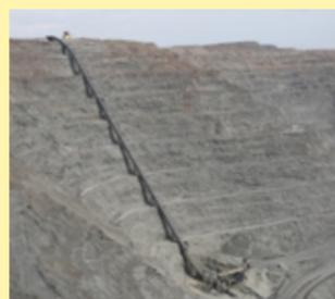
Также на «Мурунтау» работает уникальный по своей мощности крутонаклонный конвейер КНК-270, позволяющий транспортировать руду на высоту 270 м вверх из карьера и осуществлять ее перегрузку с конвейера на автотранспорт. Производительность КНК-270 составляет 14 млн т руды в год.
